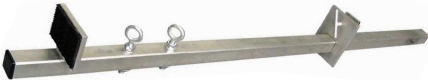
anclaje de seguridad transportable en acero galvanizado para 1 usuario como anticaídas + 1 usuario como retención. Abertura variable de 350mm a 1240mm.
